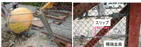
図 - 12 落石防護柵の実験 6)
