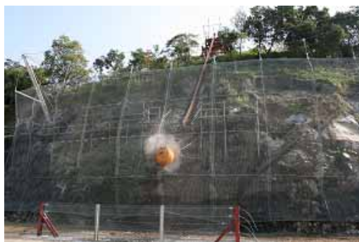
図 - 9 2.1t の重錘を速度 19.5m/s で衝突。落石エネルギーは 400kJ (第 3 回目公開実験 2008 年 12 月 8 日) 2)
